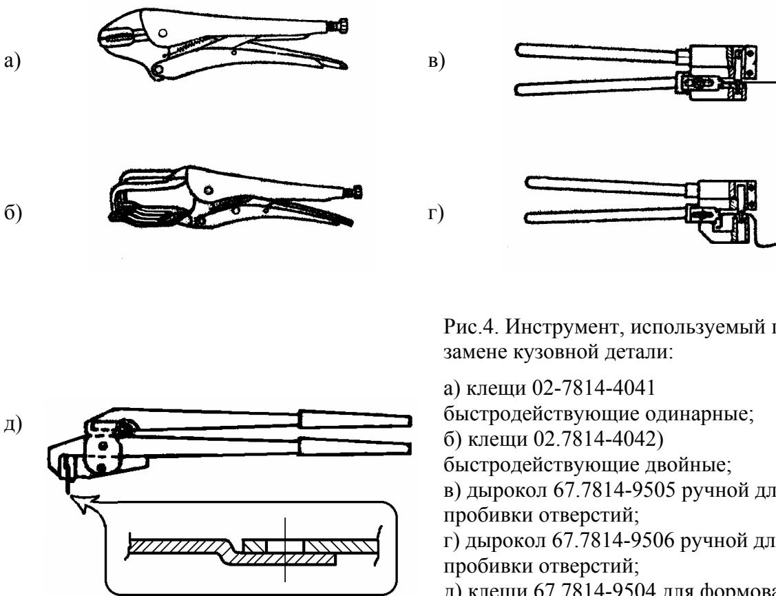
Рис.4. Инструмент, используемый при замене кузовной детали:
