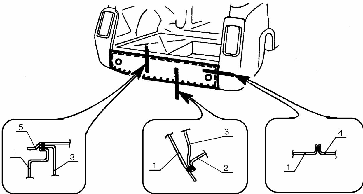
Рис.11. Соединение панели задка наружной с сопрягаемыми деталями.
