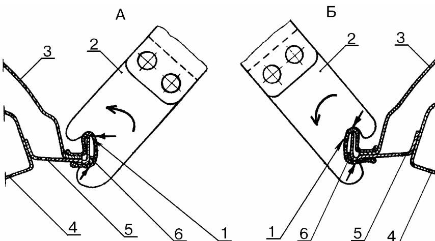
Рис.1. Снятие А и установка Б облицовочной накладки:
