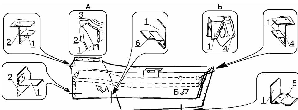
Рис.2. Соединение лонжерона заднего пола с сопрягаемыми деталями.
