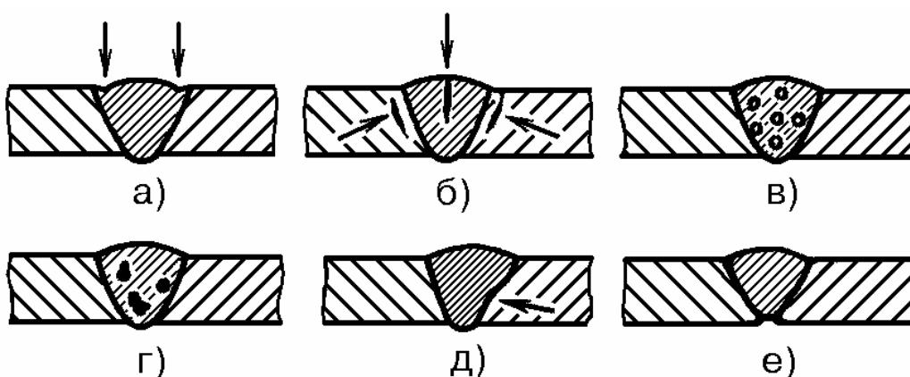
Рис.4. Поперечные сечения сварочных швов с типичными дефектами:
