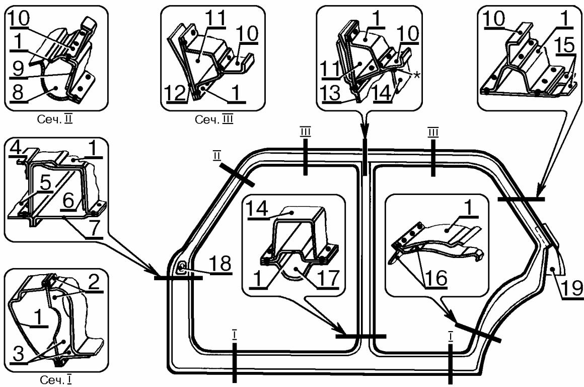
Рис.6. Соединение боковины кузова правой/левой с сопрягаемыми деталями.
