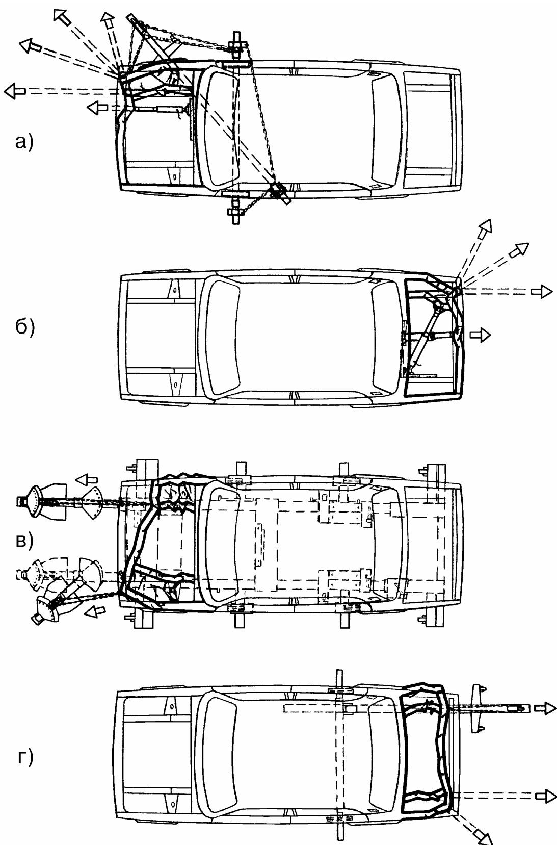
Рис.13. Варианты установки силовых устройств и растяжек для устранения перекоса кузова средней сложности.
