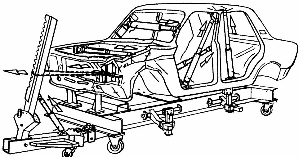
Рис.14. Варианты установки силовых устройств и растяжек при устраниении сложного перекоса кузова.
