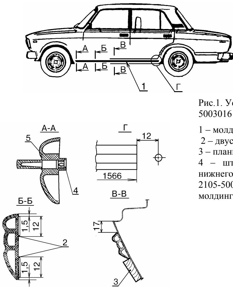
Рис.1. Установка молдинга 2105-5003016 боковины нижнего:
