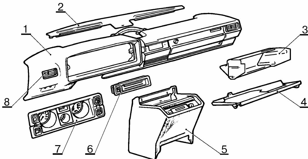
Рис.1. Панель приборов 2105-5325010 и ее принадлежности.
