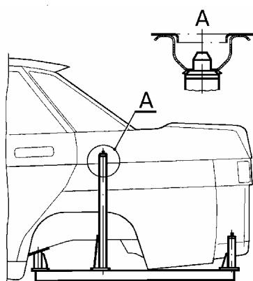
Приспособление 67.21.019 для проверки мест крепления задней подвески кузовов автомобилей ВАЗ-2110; 2111; 2112.
