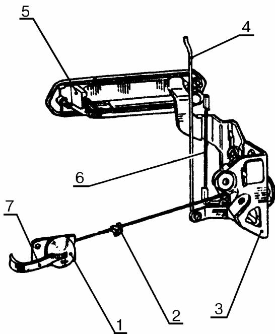
Рис. 5. Замок передней двери
