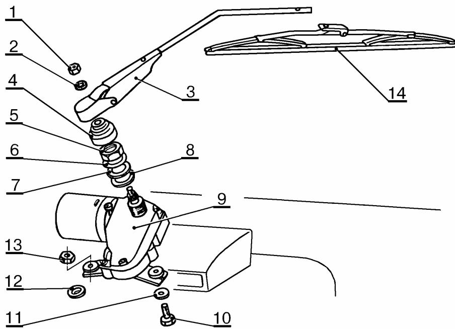
Рис.1. Детали стеклоочистителя заднего.
