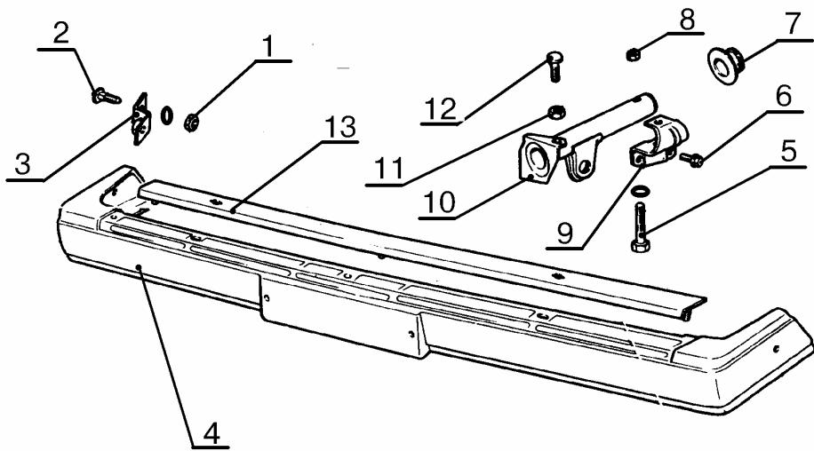
Рис.3. Бампер передний ВАЗ-2107:
