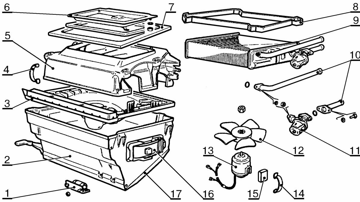
Рис.2. Детали отопителя.
