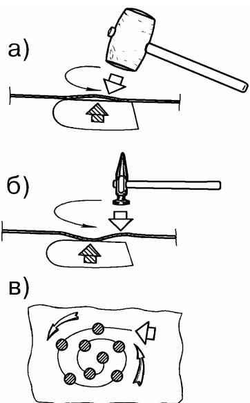
Рис.2. Выправление вмятины, не имеющей большой вытяжки металла:
