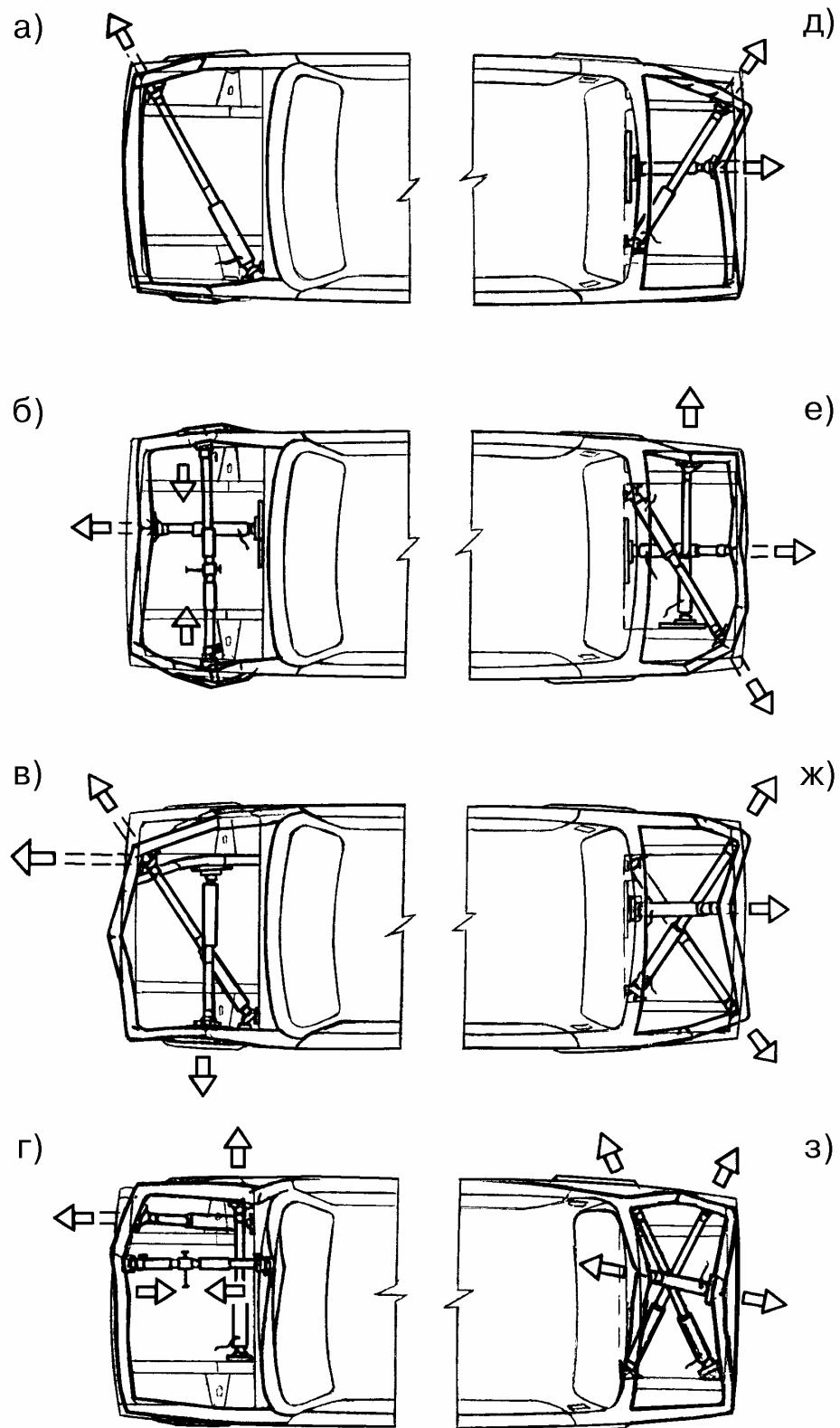
Рис.12. Варианты установки растяжек для устранения несложного перекоса проема капота или проема крышки багажника.
