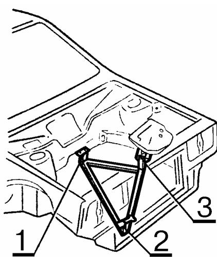
Приспособление 67.8419-9502 для проверки расположения кронштейнов крепления двигателя на кузовах автомобилей ВАЗ-2108; 2109; 21099; 2115:
