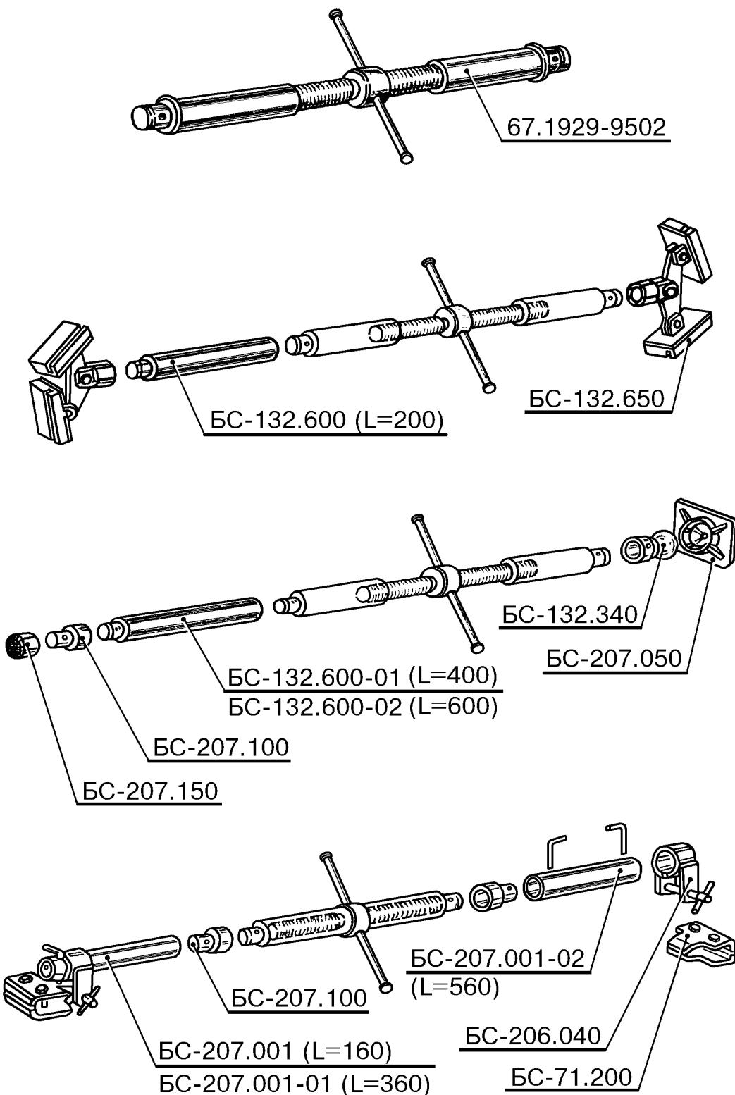
Рис.3. Варианты комплектации винтовых растяжек удлинителями, струбцинами и упорами для устранения перекосов в проемах кузова.
