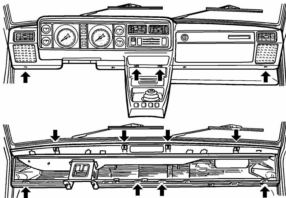
Рис.7. Крепление панели приборов 2107-5325010 к кузову (точки крепления показаны стрелками).
