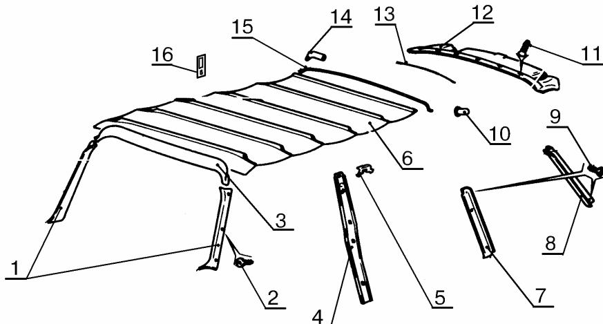
Рис.3. Обивка крыши ВАЗ-2104:
