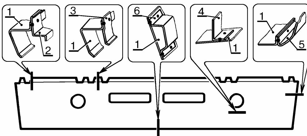
Рис.2. Соединение панели облицовки радиатора с сопрягаемыми деталями.
