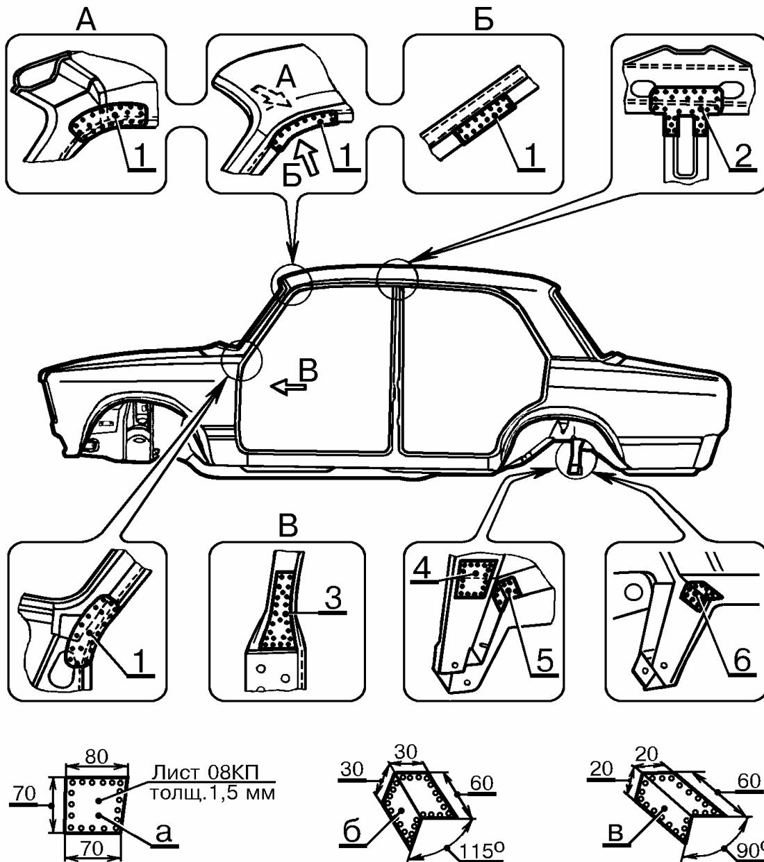
Рис.7. Места установки и приварки усилительных накладок на кузове.
