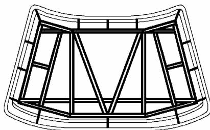
Приспособление 67.21.023 для ремонта проема ветрового окна автомобилей ВАЗ-2110; 2111; 2112.
