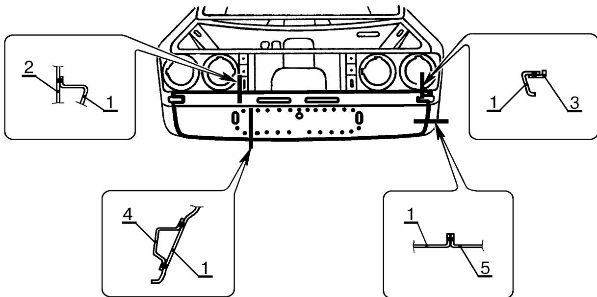
Рис.14. Соединение панели передка нижней с сопрягаемыми деталями.
