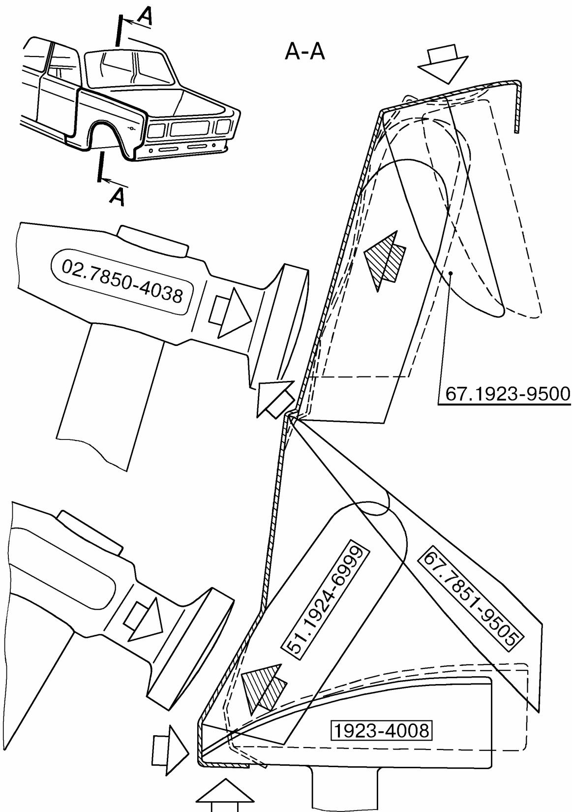
Рис.8. Рекомендуемые фасонные наковаленки (поддержки) для устранения деформаций с учетом кривизны поверхности переднего крыла, сеч. А-А.
