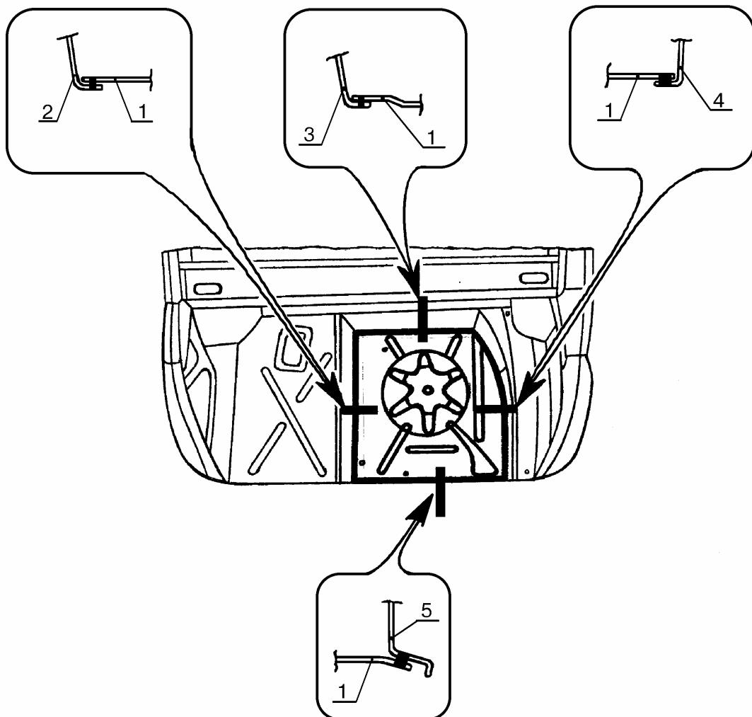
Рис.8. Соединение панели пола заднего с сопрягаемыми деталями.
