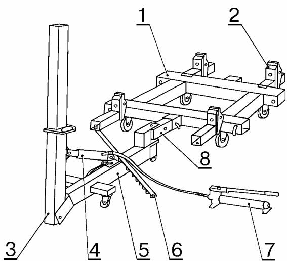
Рис.7. Общий вид универсального стенда для правки кузовов легковых автомобилей (миниробот), модель 67.21.015:
