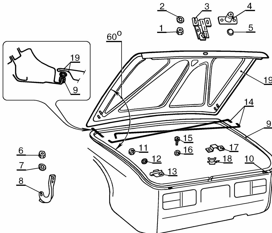
Рис.1 Детали крышки багажника.
