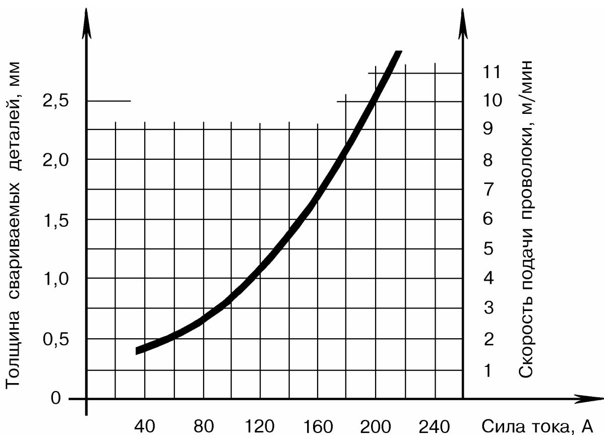
Рис.7. Зависимость силы тока и скорости подачи проволоки от толщины свариваемых деталей при диаметре сварочной проволоки 0,8 мм.
