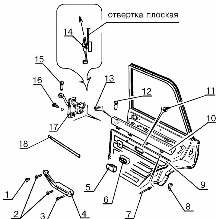
Рис.1. Дверь задняя ВАЗ-2105, 2107, 2106:
