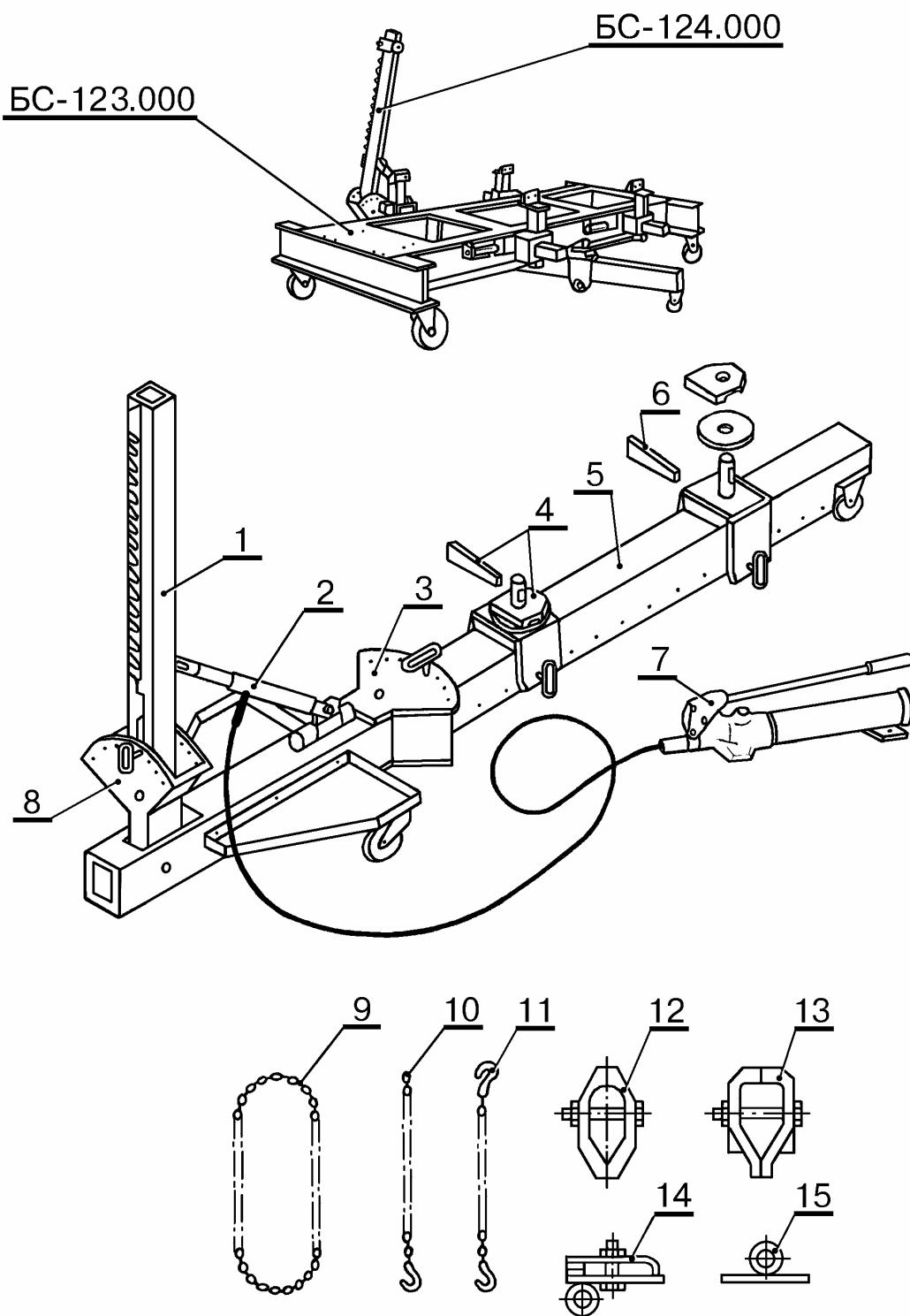
Рис.8. Общий вид устройства для правки кузовов БС-124.000 со стендом БС-123.000:
