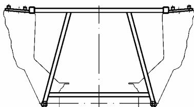
Приспособление 67.21.009 для замены брызговика с лонжероном в сборе на кузовах автомобилей ВАЗ-2108; 2109; 21099; 2115.
