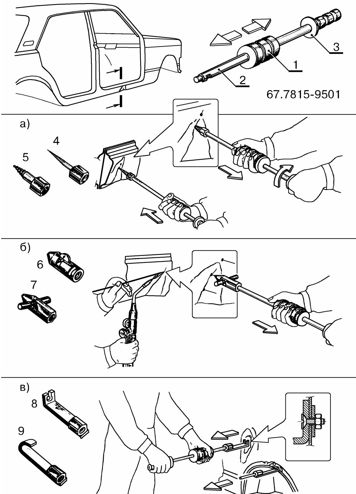
Рис.11. Исправление вмятин приспособлением ударного типа:
