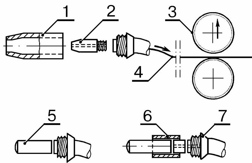
Рис.9. Схема установки медного (угольного) электрода для нагрева и усадки металла:
