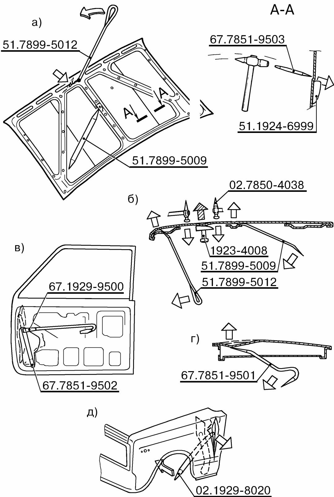
Рис.9. Исправление вмятин в труднодоступных местах:
