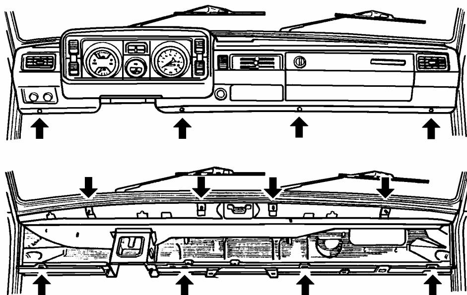
Рис.2. Крепление панели приборов 2105-5325010 к кузову (точки крепления показаны стрелками).
