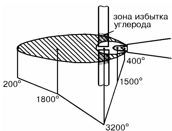
Рис.1. Распределение температуры в пламени кислородно-ацетиленовой горелки.
