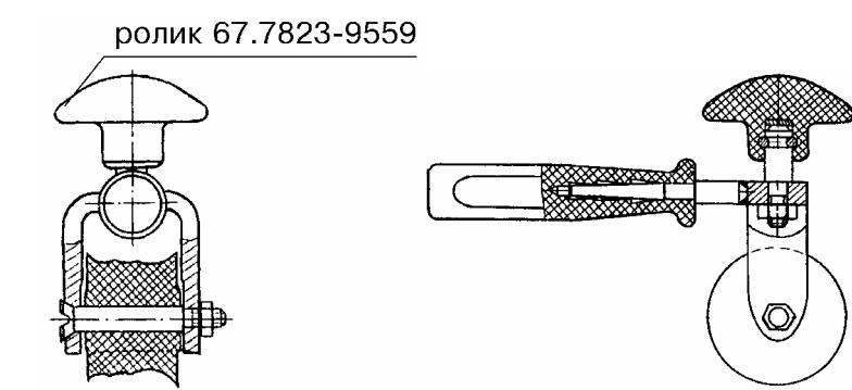
Рис.2. Ролик для прикатки молдинга 2105-5003016 нижнего.
