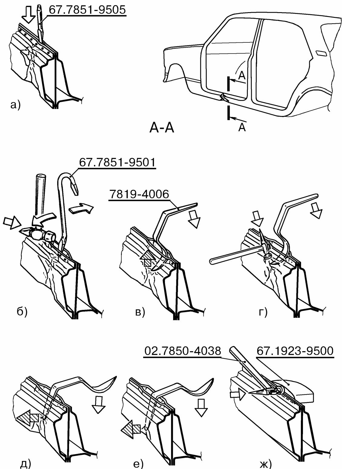
Рис.10. Устранение вмятин на панелях порога:
