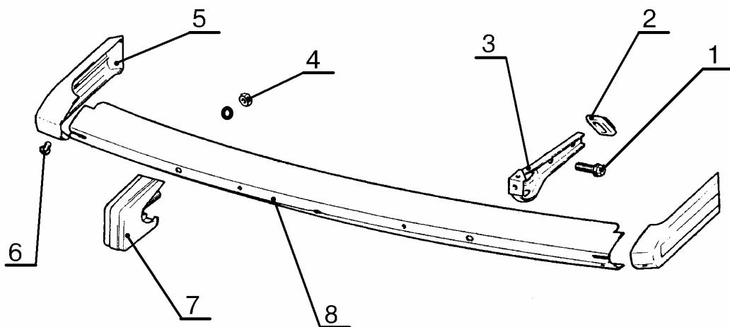
Рис.5. Бампер передний ВАЗ-2106:
