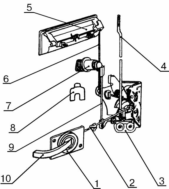
Рис.4. Замок передней двери ВАЗ-2105:
