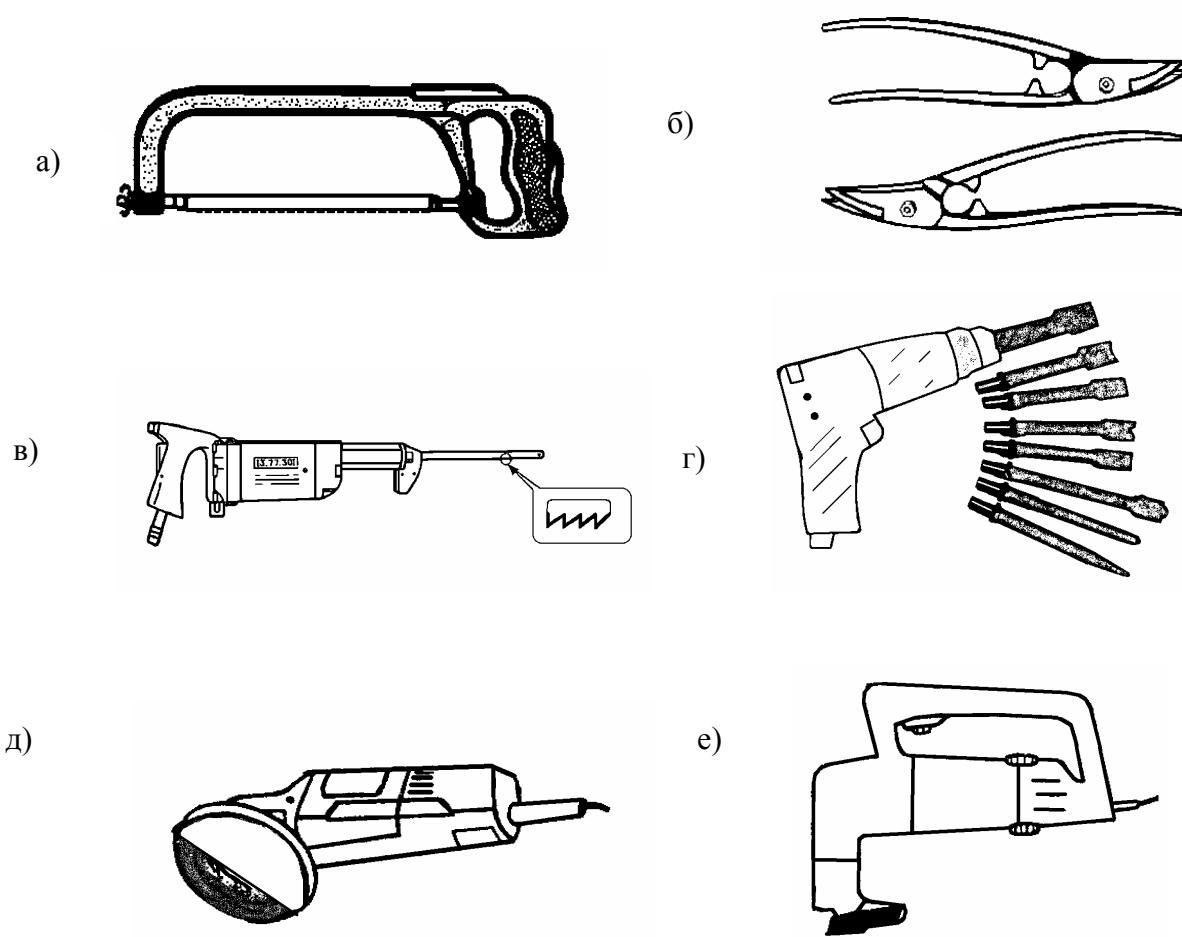
Рис.2. Инструмент для резки деталей кузова
