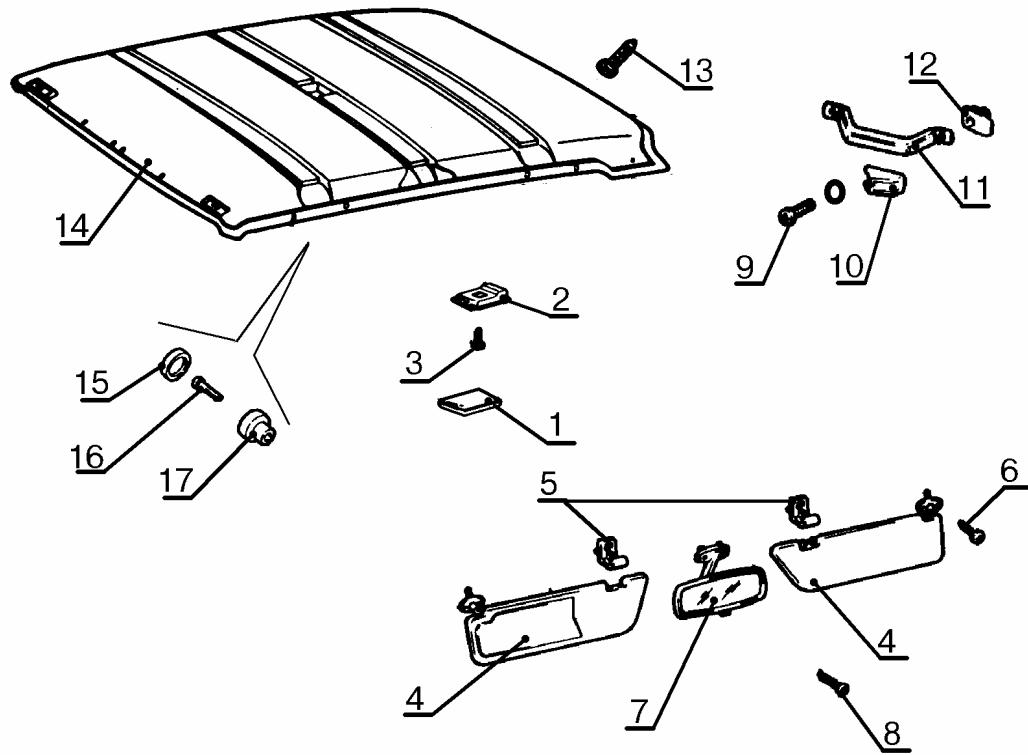
Рис.1.Крепление обивки крыши.
