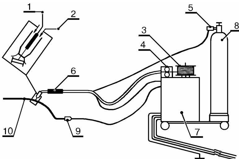
Рис.3. Схема полуавтоматической установки МИГ (металл – инертный газ):
