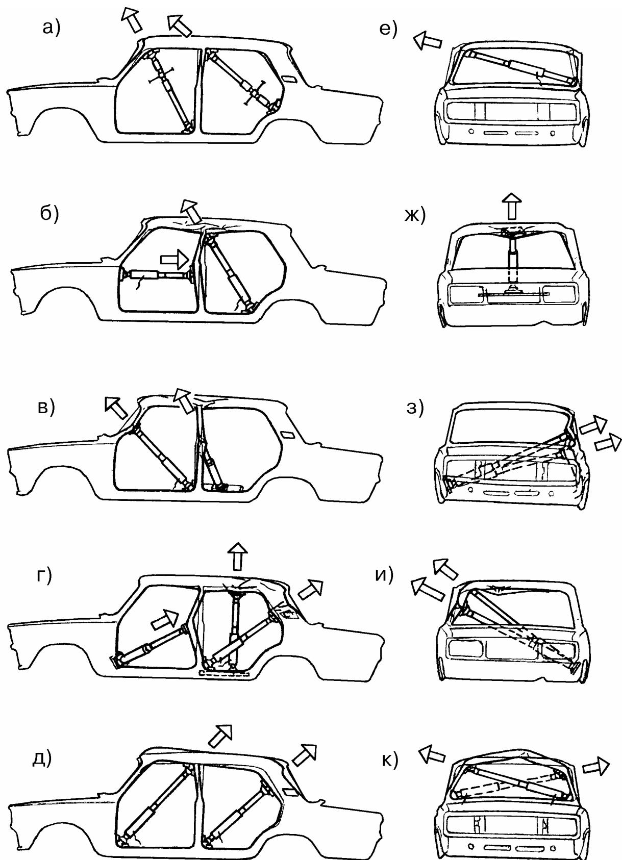
Рис.11. Варианты установки растяжек для устранения перекосов проемов окон и дверей.
