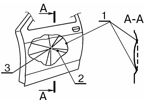
Рис.1. Деформация (вмятина) наружной панели двери.
