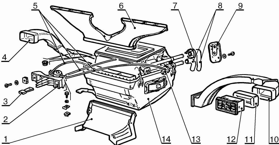
Рис.1. Детали отопителя.
