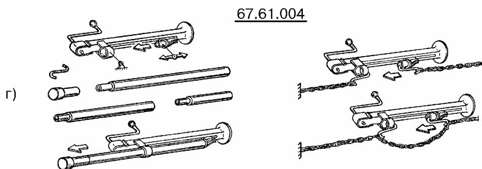
Рис.4. Силовые устройства для устранения перекосов проемов кузова:
