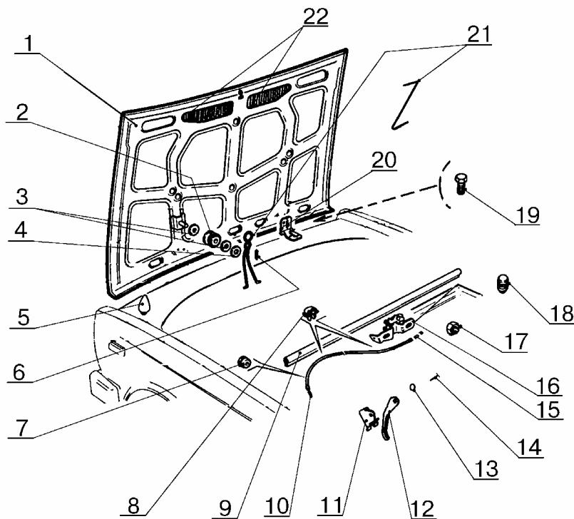
Рис. 1. Капот и его механизмы:
