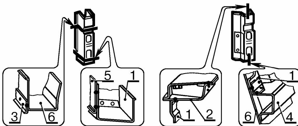
Рис.4. Соединение стойки рамки радиатора с сопрягаемыми деталями.
