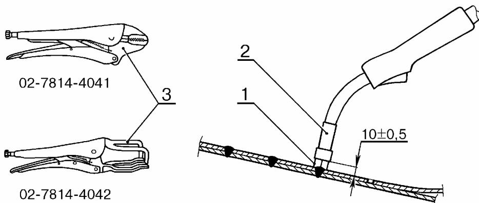
Рис.8. Выполнение сварочной точки.
