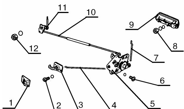
Рис.3. Замок задней двери
