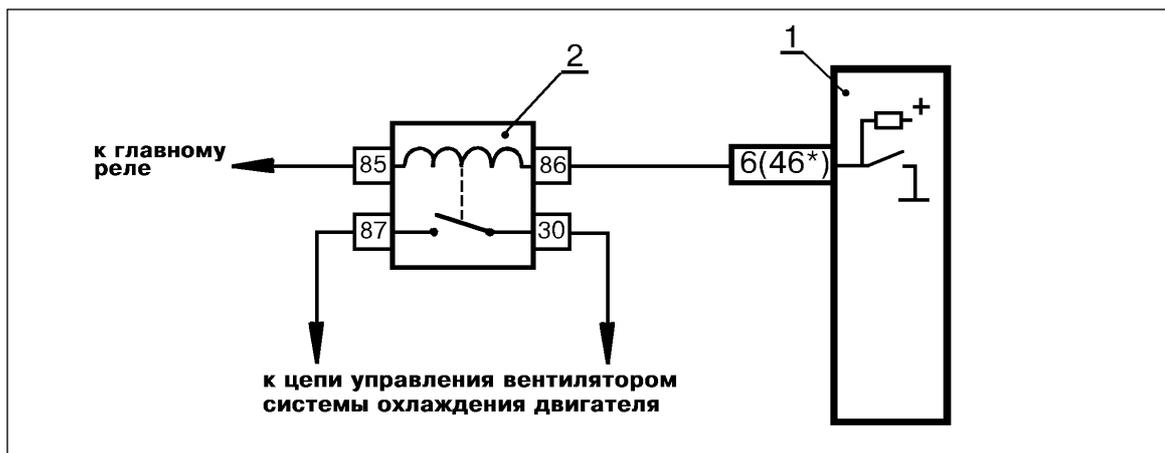
Рис.44 Схема электрических соединений реле вентилятора системы охлаждения:
