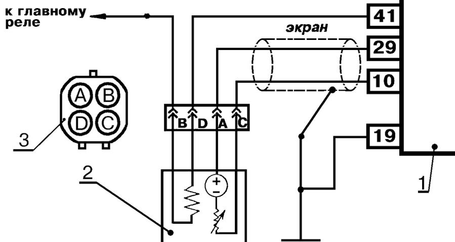
Рис.39 Схема электрических соединений диагностического датчика кислорода: 1 - контроллер; 2 - диагностический датчик кислорода; 3 - колодка жгута системы зажигания к диагностическому датчику кислорода (вид спереди).
