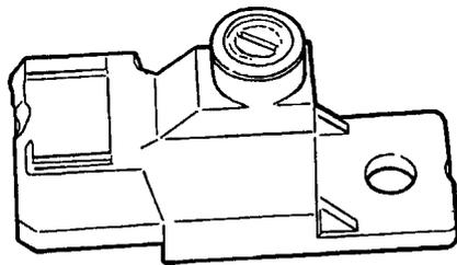
Рис.14 Внешний вид потенциометра СО
