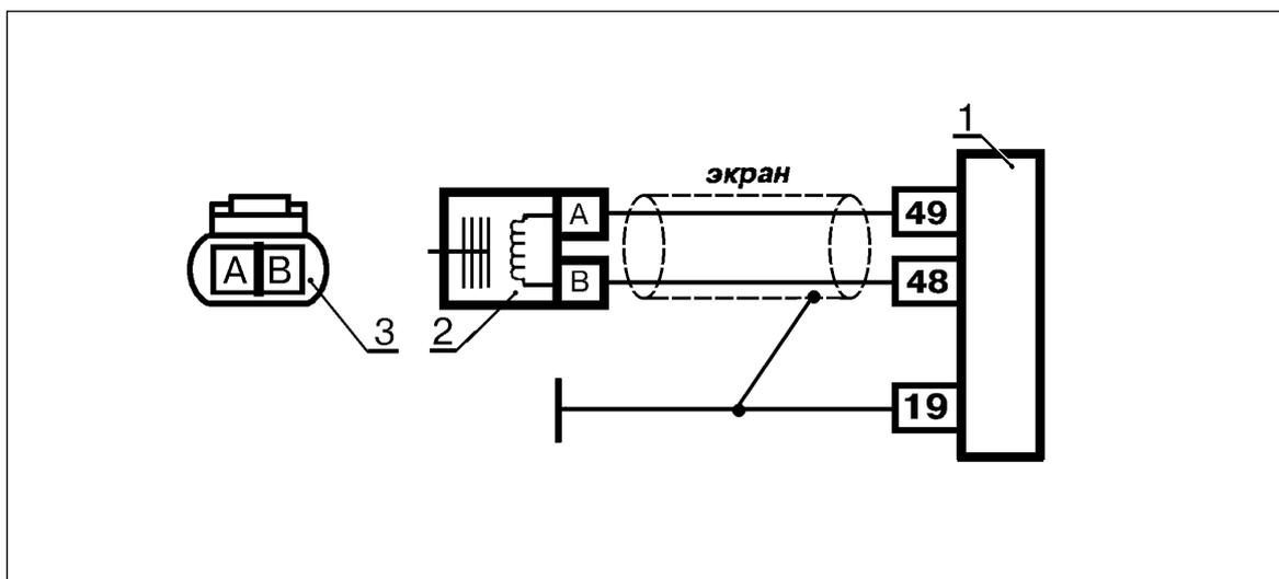
Рис.41 Схема электрических соединений датчика положения коленчатого вала:
