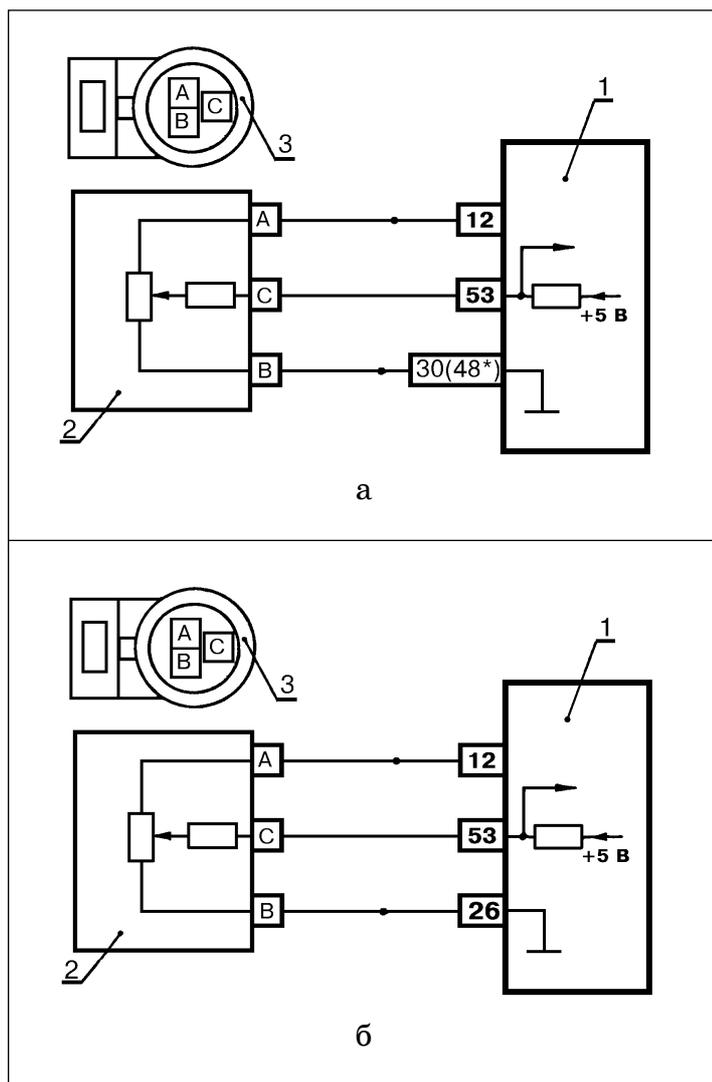
Рис.37 Схема электрических соединений датчика положения дроссельной заслонки:
