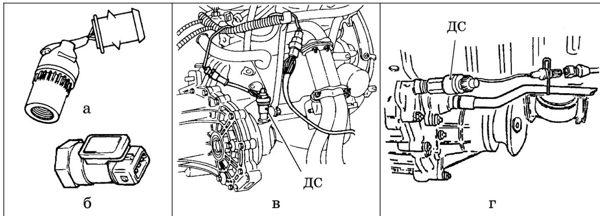
Рис.6 Внешний вид и расположение датчика скорости:
