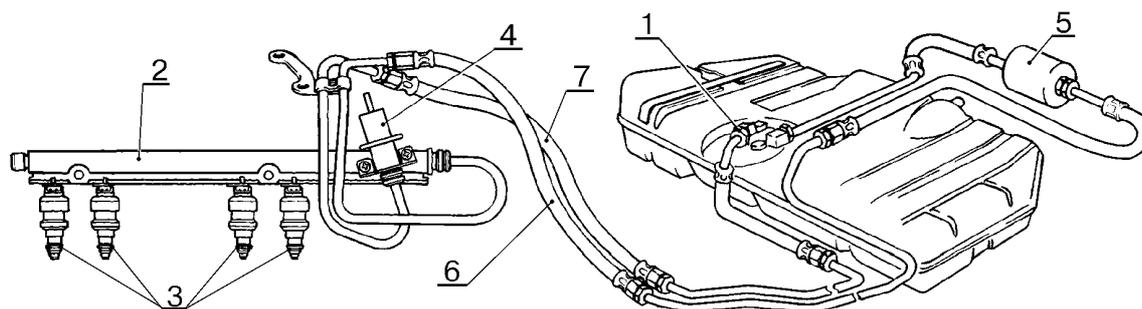
Рис.15 Система подачи топлива:
