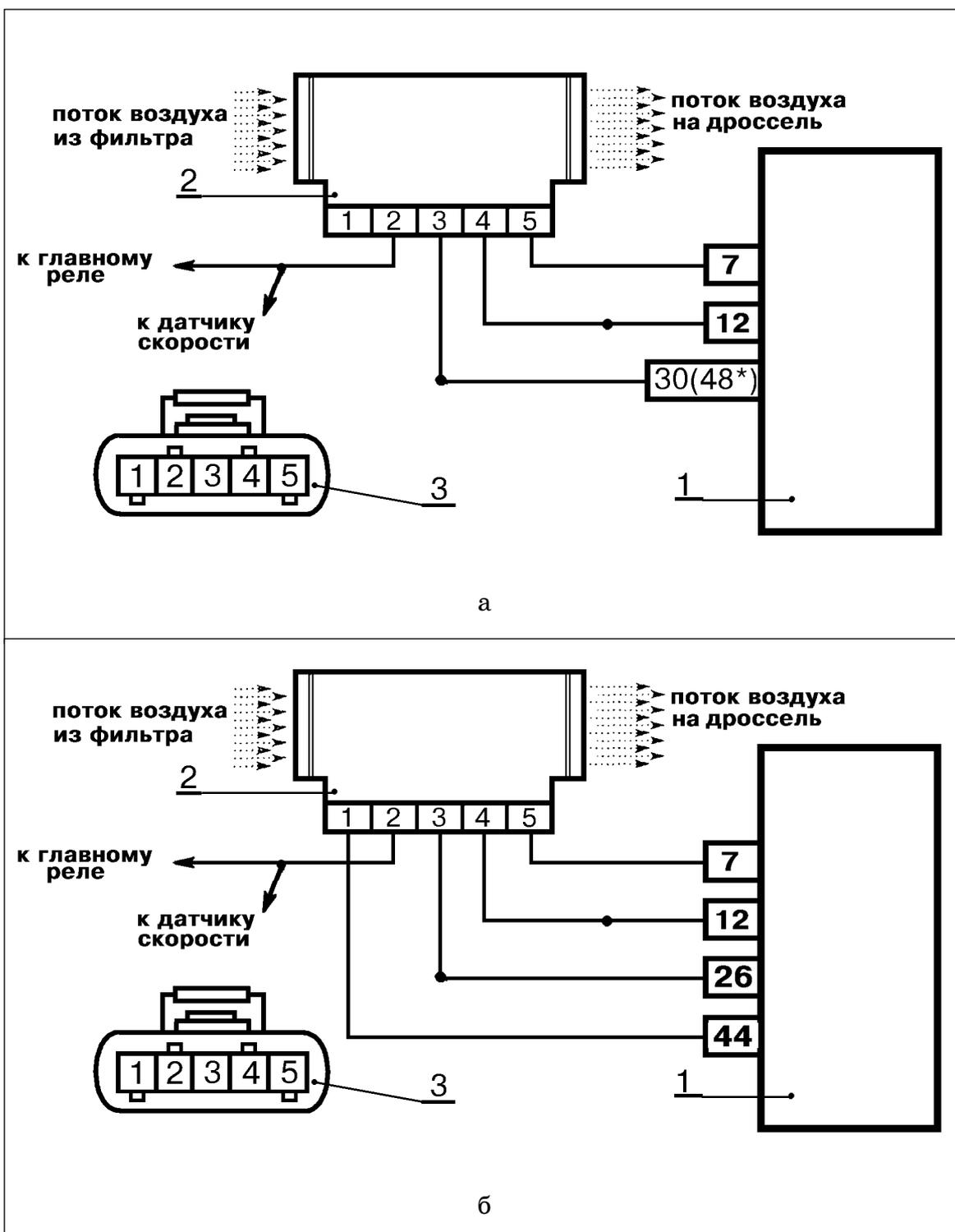
Рис.35 Схема электрических соединений датчика массового расхода воздуха:
