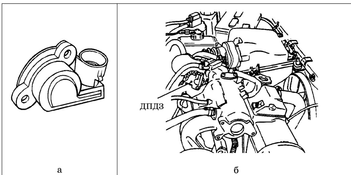
Рис.11 Внешний вид и расположение датчика положения дроссельной заслонки:
