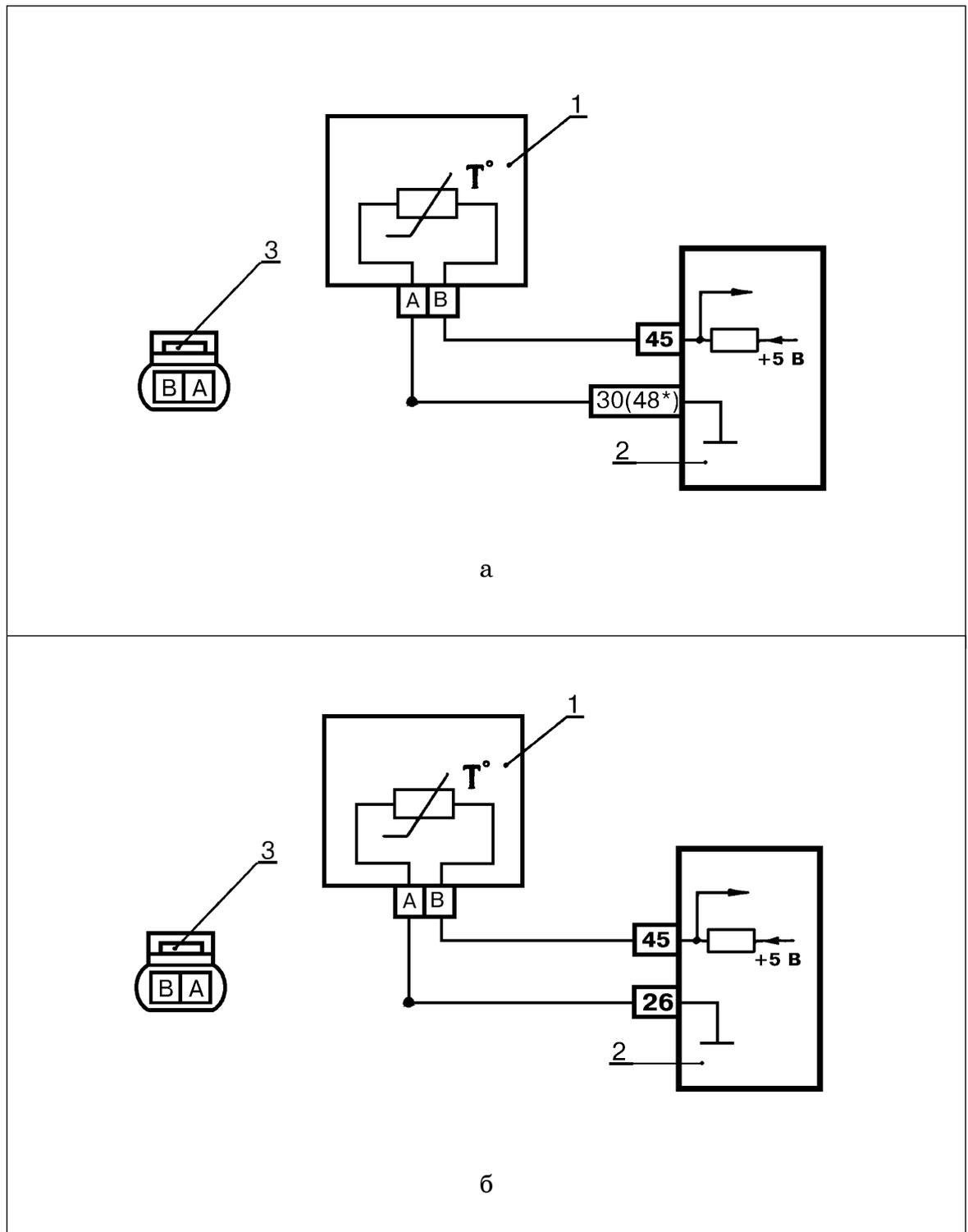
Рис.36 Схема электрических соединений датчика температуры охлаждающей жидкости:
