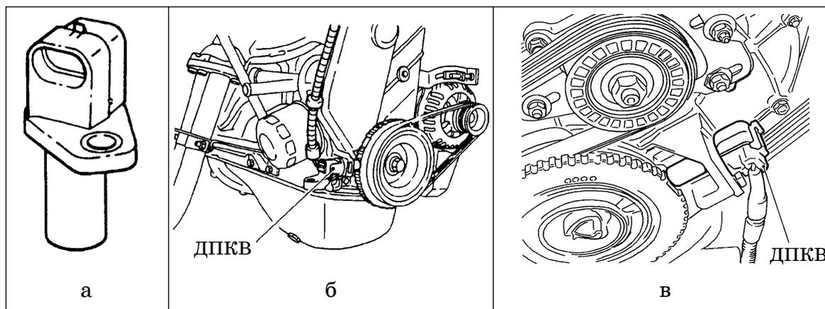
Рис.5 Внешний вид и расположение датчика положения коленчатого вала:
