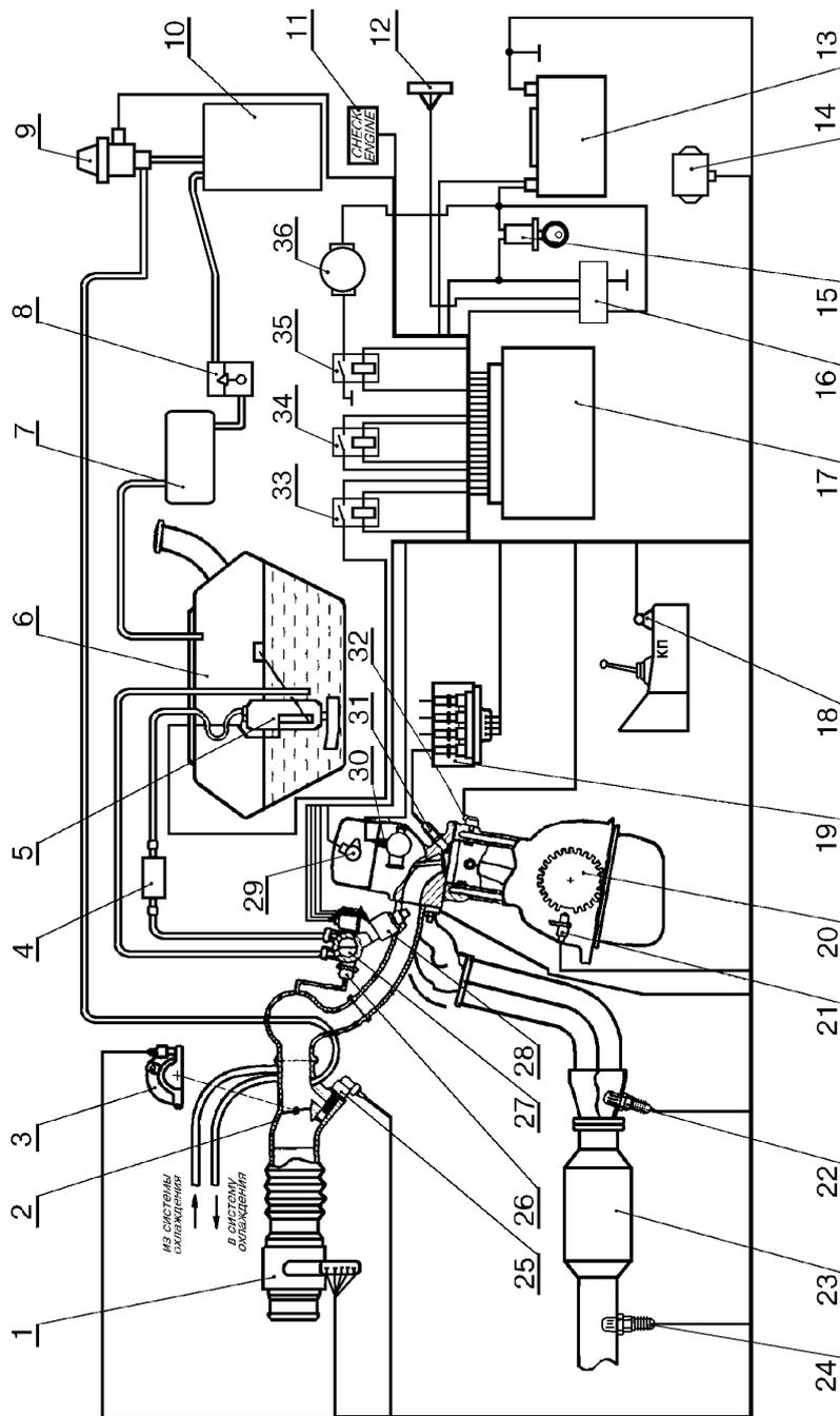
Рис.2 Принципиальная схема системы распределенного впрыска топлива с двумя датчиками кислорода, датчиком неровной дороги, нейтрализатором и системой улавливания паров бензина (ЕВРО-3):
