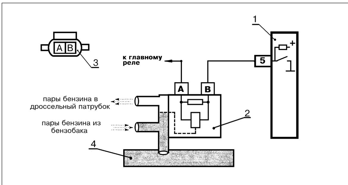
Рис.43 Схема электрических соединений электромагнитного клапана продувки адсорбера:
